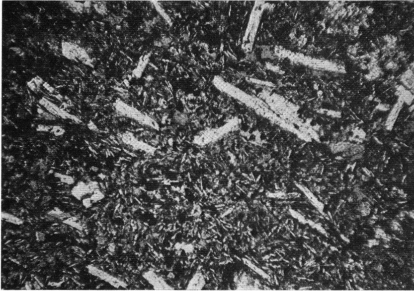
Fig. 55. Spilite à chlorite. Aspect caractéristique de la roche. Nicols \times ; V 43 \times
