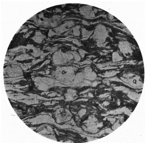
Photo 6. Paragneiss à quartz (Q), feldspath alcalin (Or) et biotite (Bi); perpendiculaire à la linéation; texture lenticulaire. Au Nord de Caussou. Gross. lin. 25 X; lumière naturelle.
