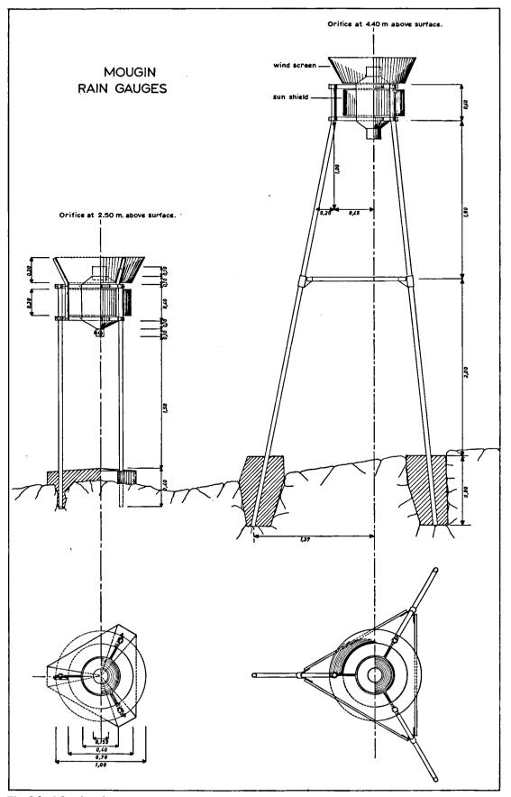
Fig. 3.3 Mougin rain gauges.
