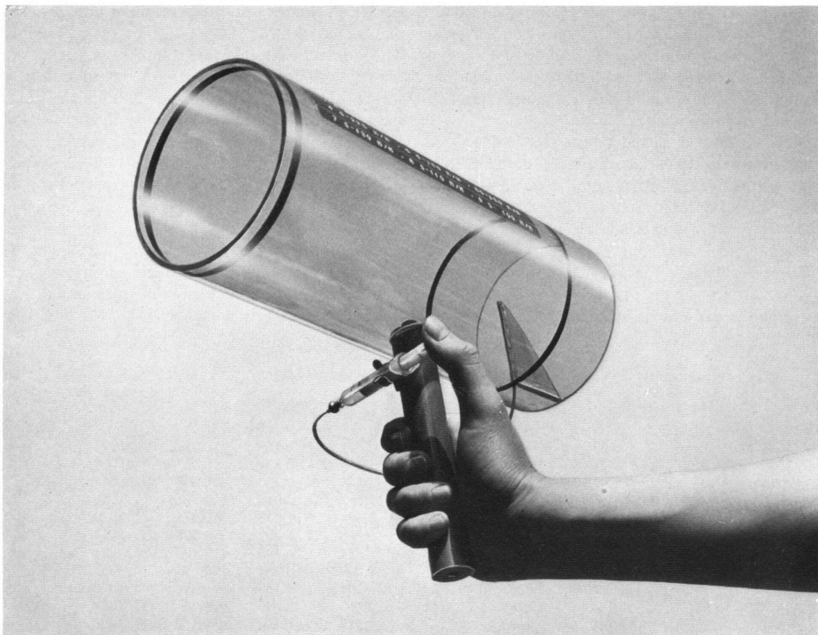
Fig. 6. Le courantomètre à nuage d'encre que nous avons employé.
