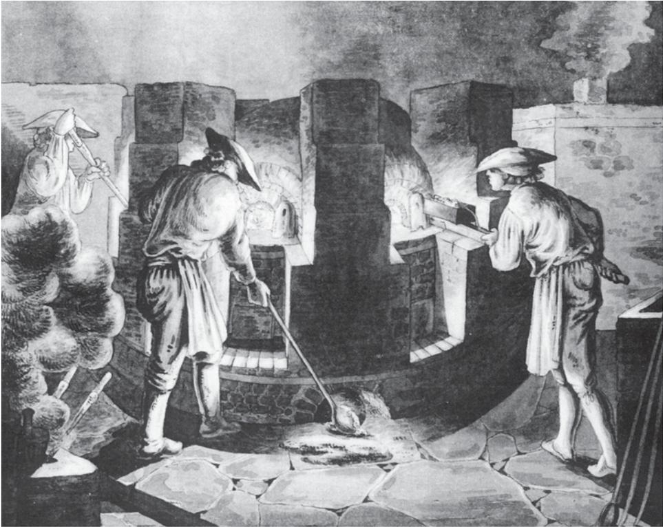
Abb. 4. Die harte Arbeit unter sengender Hitze am Glühofen. Das Schmelzen der Smalte wurde in Häfen aus Ton bei 1100 bis 1250°C vorgenommen. Der Hüttenmann rechts beschickt den Ofen, links wird die glühende Smalte entnommen (Winckler, 1790). (The tough work at the furnace at temperatures of 1100 to 1250°C.)
