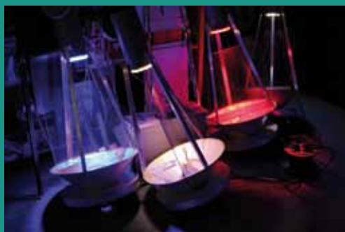
Foto 8.7 Verschillende lampen zijn getest op aantrekking van nachtvlinders. Nachtvlinders komen met name af op lampen die licht met kleine golflengte uitzenden (met name uv-licht). Rood licht (met grote golflengte) is het minst aantrekkelijk. Foto: Kars Veling.
