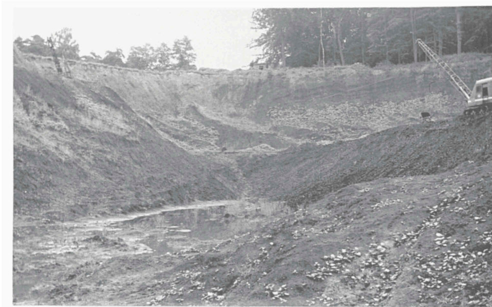
Abb. 1. Tongrube der Ziegelei O. Sunder, Twistringen, 1968. Im oberen Teil des Profils liegen etwa 2 m Sande und Tone des Quartärs. Das Miocän (an dieser Stelle etwa 16 m) wurde in zwei Sohlen abgegraben. Die tiefere Ausgrabung, vom Bagger rechts im Bild durchgeführt, wurde etwa 1966 angefangen. Für eine genaue Beschreibung dieses Profils siehe Cadée & Janssen, 1968. Photo: A. Haandrikman.
