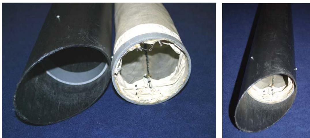
Figuur 10. De gemodificeerde buis van de bladblazer. Links is de ring in de buis te zien waarachter het netje klem gezet wordt. Rechts is het netje in de buis gemonteerd. Bij het zuigen wordt zo alles opgevangen in het netje.
