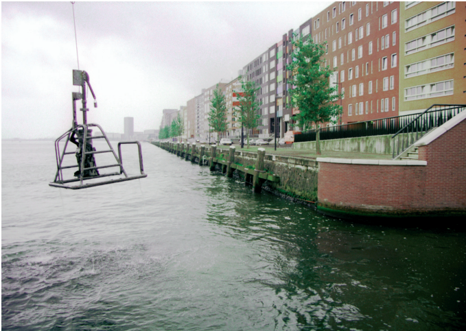
Figuur 9. Bemonstering met een boxcorer bij Amsterdam Figure 9. Boxcorer sampling near Amsterdam.
